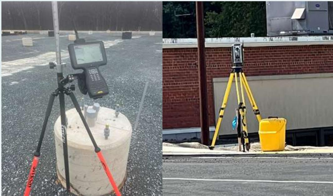
**Figura 4. Medición GNSS para el sistema de catenaria aérea (izq.) y para el replanteo de un poste de luz (der.).**
