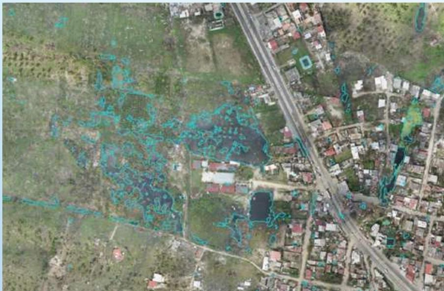
**Fig. 2. Detección automatizada de zonas con presencia de agua mediante técnicas de deep learning aplicadas a imagen aérea. Las zonas inundadas se delimitan en color azul.**
