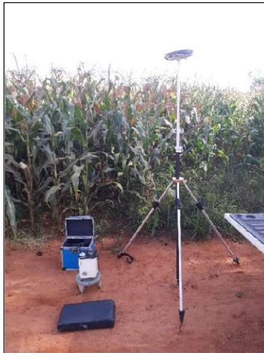
Figura 3 – Levantamento gravimétrico acompanhado de medição GNSS.
