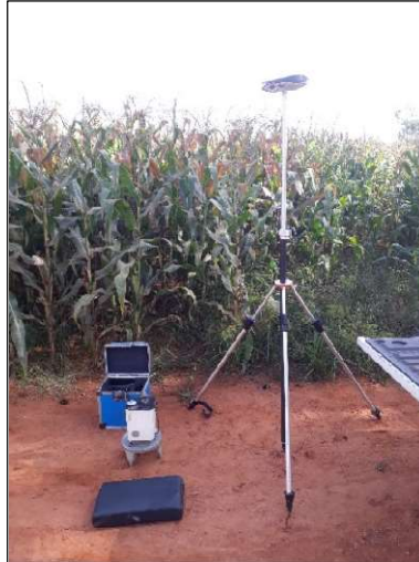
Figura 3 – Levantamiento gravimétrico acompañado de medición GNSS.
