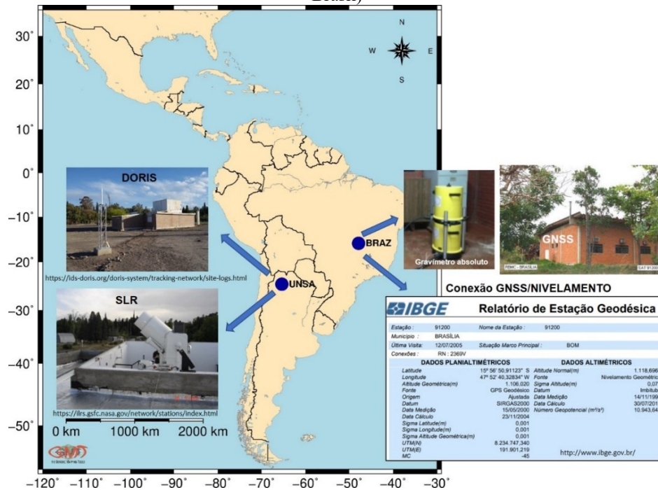
Figura 1 – Exemplo da estação IHRF colocalizada (estação UNSA, Argentina) e estação IHRF com medição de gravidade absoluta e conexão ao Datum vertical local – GNSS/nivelamento (estação BRAZ, Brasil)
