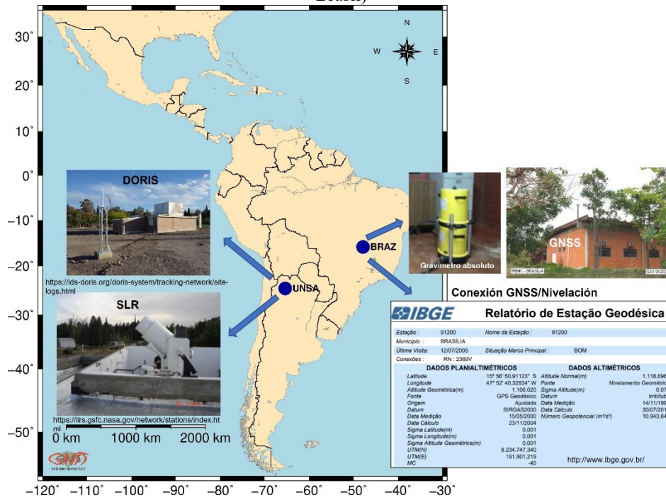
Figura 1 – Ejemplo de estación IHRF co-localizada (estación UNSA, Argentina) y estación IHRF con medición de gravedad absoluta y conexión al datum vertical local - GNSS / nivelación (estación BRAZ, Brasil)
