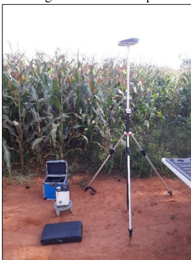
Figura 3 – Levantamiento gravimétrico acompañado de medición GNSS.
