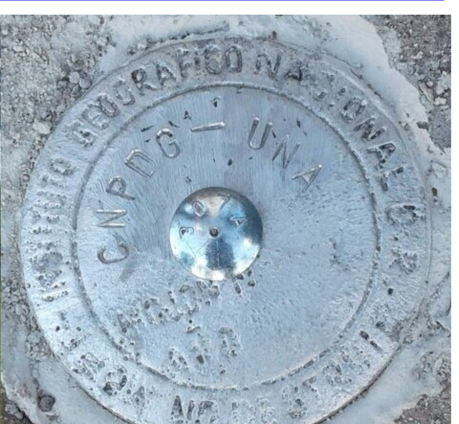
FIGURA 6. PLACA UTILIZADA PARA TRIANGULACIÓN.
