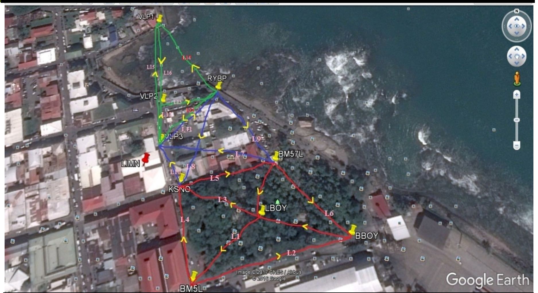
FIGURA 7. RED VERTICAL PARA EL MONITOREO DE LA ESTACIÓN LIMN, UBICADA EN LA PROVINCIA DE LIMÓN.
