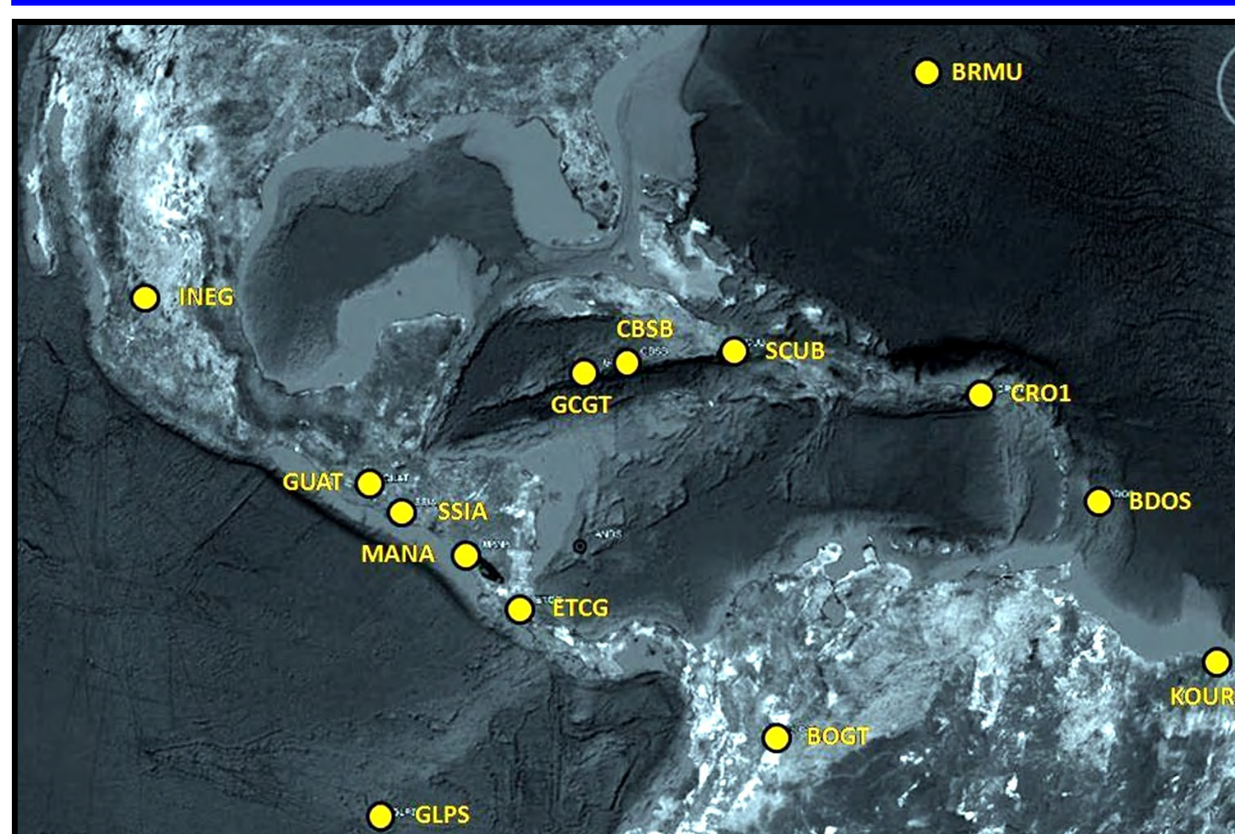
Figura 1. Localización de la red de estaciones GNSS usada, la cual se escogió con base en la ubicación, disponibilidad de las observaciones y su condición dentro de la red SIRGAS-CON.
