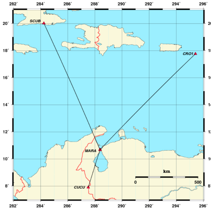
Figura 2: Configuración geométrica de la red geodésica conformada para el cálculo del ZWD en la estación SIRGAS-REGVEN-REMOS Maracaibo (MARA)
